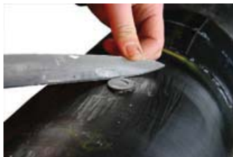
9.h. Snijdt voorzichtig de lipjes van de ventilatiepluggen.
