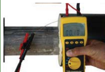
1.c. Maak verbinding met de Meggermeter tussen de beide losse lekbewakings-draadjes. De uitkomst van de meetresultaten dient zeer klein te zijn. Indien de Ohmseweerstand groot of oneindig is, mag de buis of component niet worden ingelast en is vervolg onderzoek noodzakelijk.
