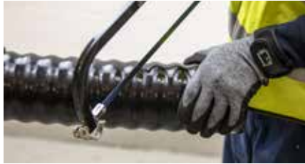
2. Mantel mit Säge am Umfang durchtrennen.
